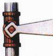
**ЗАКРЫТЬ КРАН НА ОТВОДЕ К ГАЗОВЫМ ПРИБОРАМ**
